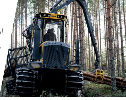
Als intelligentes System ist ETC selbstlernend, das heißt, dass es sich während des Einsatzes laufend anpasst und weiterentwickelt. Die Sensorfunktion sorgt für eine weiche und präzisere Bewegung und Positionierung des Krans. Die Anordnung der Sensoren am Kran garantiert ein robustes und zuverlässiges System, das sich einfach und komfortabel warten lässt.
