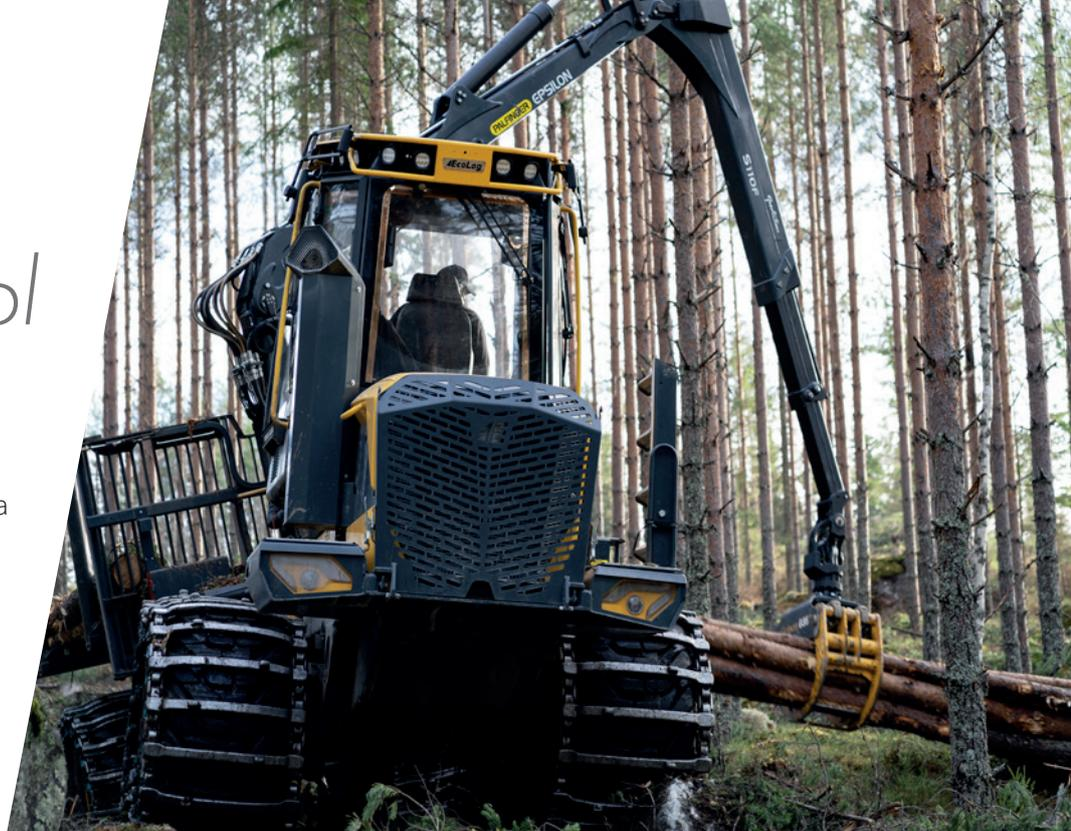
ETC es un sistema inteligente, lo que significa que es autodidacta y, por lo tanto, se adapta y se desarrolla a medida que lo va utilizando. Gracias a la función del sensor, se obtienen un movimiento y una posición de la grúa más suaves y precisos. La ubicación de los sensores en la grúa proporciona un sistema resistente y fiable cuyo mantenimiento se realiza de manera rápida y sencilla.
