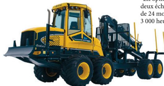
La lame avant (option) est faite pour conserver un angle d'approche important en position relevée.
