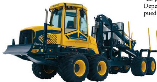
574D con pala opcional. Construida para mantener el ángulo de aproximación frontal cuando la pala está en posición superior.
